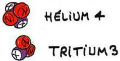
Autrement dit, l'enveloppe de lithium 6 se comporte comme un matériau "fertile". Cette réaction est censée fournir du "carburant de fusion", du tritium 3.
