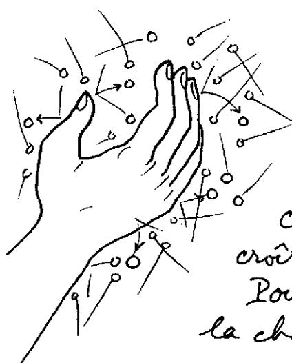
Un objet placé dans un fluide est soumis à une infinité de microchocs moléculaires. De cette manière, les molécules peuvent transmettre, échanger de l'énergie, de la CHALEUR. Le pouvoir de transmettre de la chaleur croît avec la densité du fluide.
