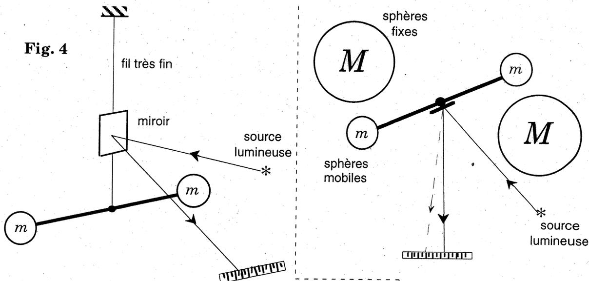
Fig. 4 Pendule de torsion de Cavendish, vue "perspective",  $M$  non représentées.
