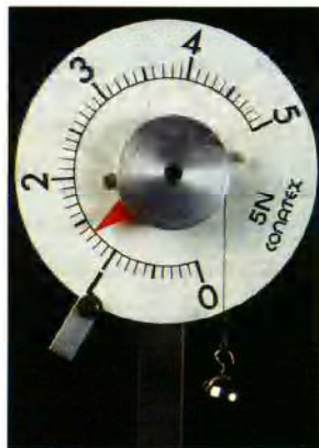
Un dynamomètre permet de mesurer des intensités de forces.
