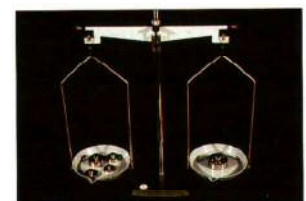
On utilise une balance à plateaux pour mesurer les masses.
