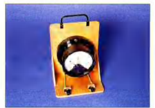
On mesure l'intensité du courant électrique avec un ampèremètre.
