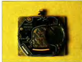
Intérieur d'une montre à quartz à aiguilles.
