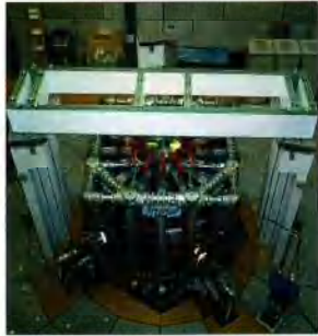
Un réacteur expérimental pour la fusion nucléaire: le Tokamak. (Photo: CERN, Centre de recherches en physique des plasmas, Lausanne)
