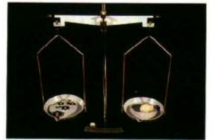
Le rébrachet est encore utilisé par les pharmaciens et les joailliers.
