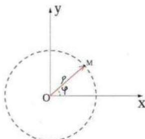
A un point  $P(x; y)$  correspond un couple  $(\rho; \varphi)$  où  $\rho$  est la distance de  $P$  à l'origine et  $\varphi$  l'angle entre  $Ox$  et  $OP$ .
