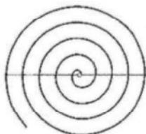
C) Spirale logarithmique :  $\rho = e^{m\varphi}$ ,  $\varphi \in ]-\infty; \infty[$ . Le point 0 est un point asymptote.
