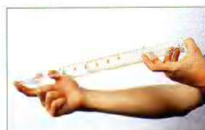
Compression d'un gaz à l'aide d'une seringue.
