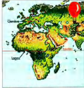
Variation de la force de pesanteur d'un corps sur Terre. Lagos 6° 27'N F_p = 100,00\text{ N} Genève 46° 10'N F_p = 100,25\text{ N} Ballon (altitude: 10000 m) F_p = 99,95\text{ N}
