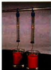
La force d'Archimède est plus grande dans l'eau salée, de masse volumique 1200 \text{ kg} \cdot \text{m}^{-3} (à gauche) que dans l'eau pure, de masse volumique 1000 \text{ kg} \cdot \text{m}^{-3} (à droite).
