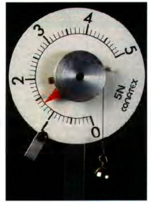
Mesure de l'intensité de la force de pesanteur d'un corps à l'aide d'un dynamomètre rotatif.
