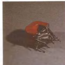
La force d'interaction magnétique qui retient les clous contre l'aimant.
