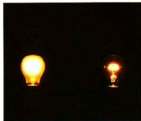
La chaleur dégagée lors du passage du courant dans le filament provoque son incandescence. Le verre opalifié de l'ampoule diffuse la lumière émise par le filament.
