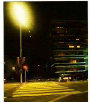
Passage pour piétons éclairé par des lampes à vapeur de sodium.
