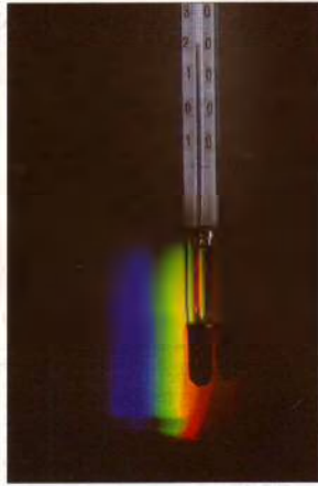
Le thermomètre, dont le réservoir a été noirci, s'échauffe, prouvant ainsi la présence d'infrarouge.
