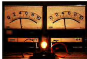
Mesure de la puissance d'une ampoule.
