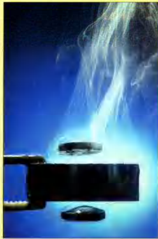
Effet Meissner. L'image représente l'extrémité d'une pincette qui tient un aimant (au centre). Au-dessus et au-dessous «lévitent» deux pastilles de matériau supraconducteur. L'aimant induit un courant électrique dans les pastilles. Ce courant persiste à cause de l'absence de résistance électrique des pastilles. L'interaction de ce courant électrique avec l'aimant provoque l'effet de lévitation.
