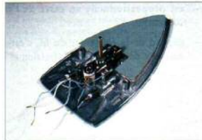
Corps de chauffe d'un fer à repasser.
