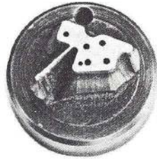
Poinçon d'horlogerie Trous exécutés sur machine Sip-Agie MP-1-EE
