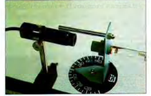
Le compteur Geiger-Müller, instrument de mesure de la radioactivité.
