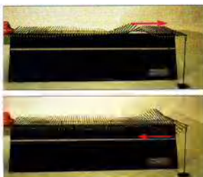
Réflexion d'une onde avec renversement de l'onde réfléchie.
