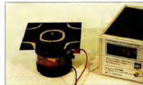
Figure de Chladni, fréquence de 3000 Hz.
