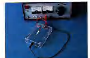
Expérience d'Oersted. Aucun courant ne circule dans le fil au-dessus de l'aiguille de la boussole.
