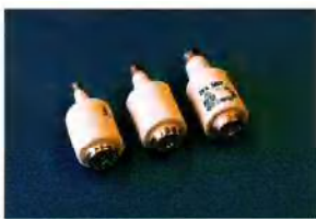
Un code de couleurs permet de reconnaître le courant admissible par un fusible: 6 A-vert; 10 A-rouge; 16 A-gris; 20 A-bleu, etc.
