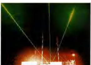
Lidar, faisceaux laser pour l'étude de phénomènes atmosphériques.
