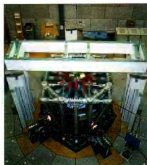
Un réacteur expérimental pour la fusion nucléaire : le Tokamak. (Photo : CRPP, Centre de recherches en physique des plasmas, Lausanne)
