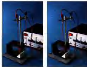
Aucun courant ne circule dans le fil rectiligne. Un courant circule dans le fil rectiligne.
