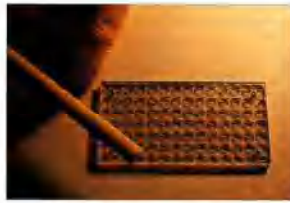
Lorsqu'on déplace la baguette chargée dans un mouvement de va et vient, les barreaux aimantés bougent.
