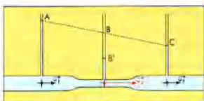
L'augmentation de la vitesse dans le tuyau de petite section entraîne une diminution de la pression.
