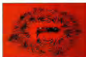
Esquisse des lignes de champ obtenue avec de la limaille de fer.
