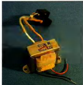
Transformateur à noyau utilisé en radio.
