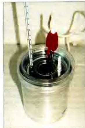
Le liquide du calorimètre reçoit un travail électrique et permet de vérifier le premier principe de la thermodynamique.
