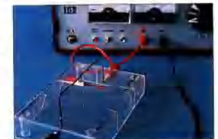
Expérience d'Oersted. Un courant circule dans le fil au-dessus de l'aiguille de la boussole.
