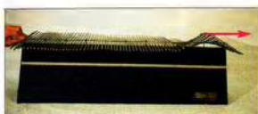
Réflexion d'une onde avec renversement de l'onde réfléchie.
