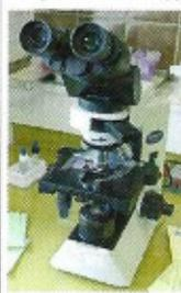
l'échantillon à observer. Celui-ci est monté entre une lame et une lamelle de verre, et il est éclairé par une lampe située en dessous de la platine, la lumière passant
