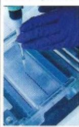
uns des autres en fonction de leur taille dans une **cuve d'électrophorèse**. Celle-ci est un récipient parallélépipédique muni d'une électrode à chacune de ses extrémités.
