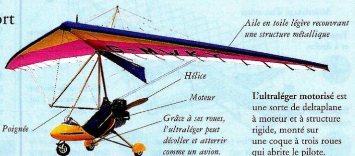
L'ultraléger motorisé est une sorte de deltaplane à moteur et à structure rigide, monté sur une coque à trois roues qui abrite le pilote.
