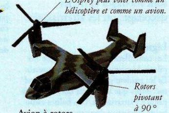
Avion à rotors pivotants, Boeing V-22 Osprey
