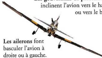
Les ailerons font basculer l'avion à droite ou à gauche.
