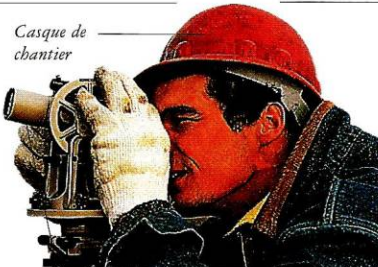
Théodolite : instrument de visée mesurant les angles, pour calculer les distances, les longueurs et les hauteurs.
