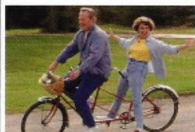
et d'un double pédalier. Les deux cyclistes doivent pédaler à la même cadence car, dans la plupart des modèles, les deux pédaliers sont reliés par la même chaîne. Il est fréquemment utilisé pour permettre aux personnes aveugles de pratiquer du vélo car le cycliste placé à l'arrière n'a pas à s'occuper du guidage. Il eut beaucoup de succès dans les années 1930 après l'instauration des congés payés car il permit aux couples d'ouvriers de se promener ensemble.
