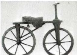
Elle avait deux roues alignées et reliées à un cadre en bois par des fourches. La roue avant pouvait pivoter latéralement à 180° et était contrôlable via un dirigeoir, timon ou gouvernail, futur guidon. La draisienne ne possédait pas de pédales et il fallait prendre appui sur le sol pour se propulser. Elle connut un certain succès en Angleterre et aux États-Unis et on loua la célérité de cette monture économique qui ne consommait ni foin ni avoine.
