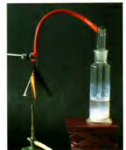
Combustion du gaz naturel: mise en évidence du dioxyde de carbone.
