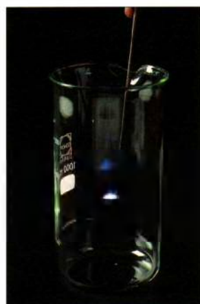
Combustion du soufre dans l'oxygène.
