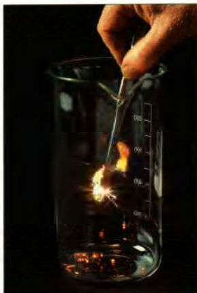
Combustion du fer dans l'oxygène.
