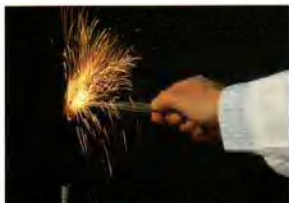
Combustion de la poudre de fer dans l'air.
