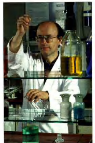
Prélèvement d'acide sulfurique à l'aide d'une pipette jaugée.
