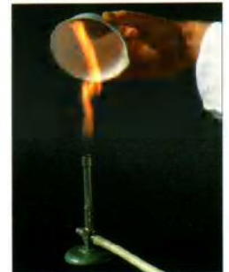
Combustion incomplète du gaz naturel: mise en évidence du carbone.
