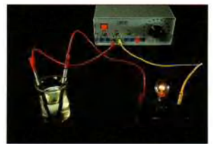
L'ampoule allumée met en évidence le passage du courant électrique.
