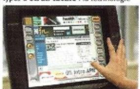
résistive (pour une utilisation privée) et les technologies à infrarouge ou capacitives (adaptées à un usage public). La technologie résistive est la plus économique et la plus simple.
