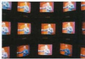
d'une télévision, on peut remarquer la déformation des images et la modification des couleurs. L'image de la télévision est créée par le balayage systématique de la surface de l'écran par le faisceau. La présence du champ magnétique modifie la trajectoire des électrons et donc la structure de l'image.
