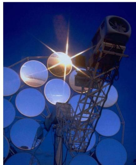
Un four solaire thermique destiné à produire de l'électricité grâce à un moteur Stirling. Il peut produire une puissance électrique de 25 kW.
