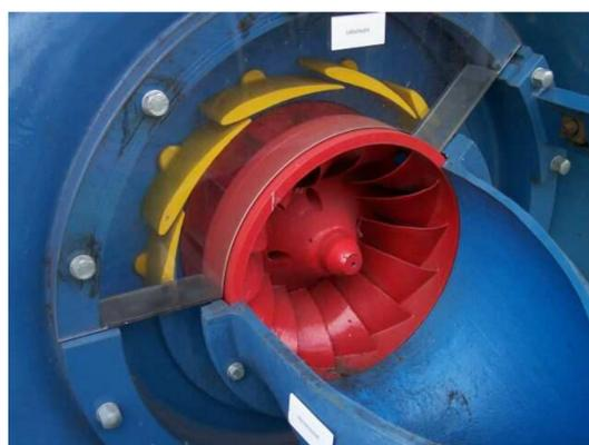
Une turbine Francis. Les techniques de production d'électricité grâce aux barrages passent par le développement de turbines performantes.
