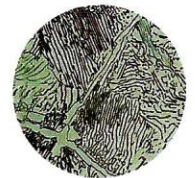
Acier en coupe : faibles traces de carbone
