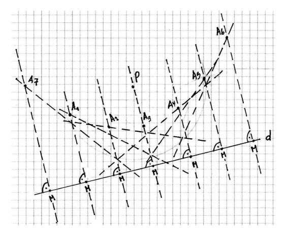
On obtient ainsi une suite de points A<sub>1</sub>, A<sub>2</sub>, A<sub>3</sub>, A<sub>4</sub>, ..., qui sont tous à égale distance de P et D. En reliant ces points, on obtient le lieu géométrique des points à égale distance de P et d (en bleu):
