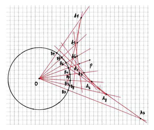
On obtient ainsi une suite de points A<sub>1</sub>, A<sub>2</sub>, A<sub>3</sub>, A<sub>4</sub>, ..., qui sont tous à égale distance de c et P. En reliant ces points, on obtient le lieu géométrique des points à égale distance de c et P (en bleu):
