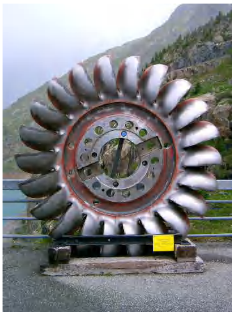
FIG. 4.5 – Ancienne turbine Pelton Barrage d'Emosson, centrale de Châtelard 43'850 kW, 500 t/min, 7135 kg en acier inox.
