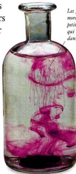
Mélange apparemment homogène. Au repos, les particules d'iode de plomb se déposent.
