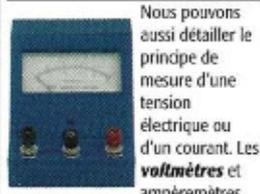
Nous pouvons aussi détailler le principe de mesure d'une tension électrique ou d'un courant. Les **voltmètres** et **ampèremètres** mécaniques fonctionnent de façon similaire à une balance mécanique dans la mesure où c'est en fait le déplacement d'une aiguille qui permet la lecture sur un cadran de la tension électrique ou du courant. Cependant, l'origine du déplacement de l'aiguille est différente. En effet,
