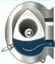
mélange frais avant de l'amener au niveau de la bougie où une étincelle entraîne la combustion. Le rotor refouillé ensuite les gaz brûlés par la lumière d'échappement et le cycle recommence. En un tour complet du piston, ce cycle se répète trois fois. Les avantages du Wankel sont sa longévité, sa fiabilité, sa compacité. Ses inconvénients sont sa consommation élevée et le fait qu'il pollue beaucoup. Aussi, il n'a pas eu le succès escompté.
