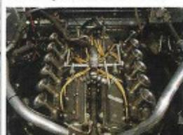
fonctionnement encore plus uniforme. Les dispositions les plus fréquentes des cylindres sont la disposition en ligne, ou en deux rangés qui, la plupart du temps forment entre elles un angle ; ces moteurs sont dits « en V » : V4, V6, V8... selon le nombre de cylindres. On emploie également la disposition en étoile, uniquement en aviation, souvent avec 7 cylindres.
