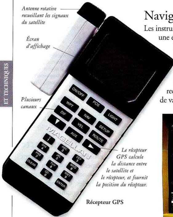
Le récepteur GPS calcule la distance entre le satellite et le récepteur, et fournit la position du récepteur.
