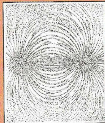
a. Lignes de force du champ magnétique engendré par un barreau aimanté.
