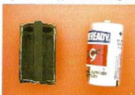
des piles « sèches » : l'électrolyte est ici non pas liquide, mais gélatineux (il consiste en un mélange de farine et d'amidon imprégné d'eau et de chlorure d'ammonium).
