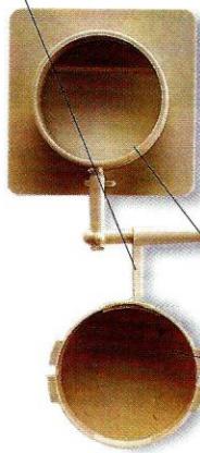
Empreinte du canal d'injection du plastique dans le moule
