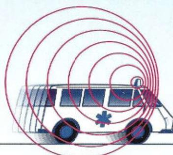
Les ondes sonores ne sont plus centrées sur le même point. Le son perçu a une fréquence plus élevée si la source s'approche et une fréquence plus basse si elle s'éloigne.
