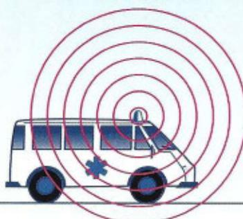
Les ondes sonores sont parfaitement concentriques. La fréquence perçue est la même, que l'on se trouve à droite ou à gauche de la source.
