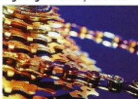
lorsque les axes de rotation sont éloignés l'un de l'autre. Par rapport au système poulie-courroie, ce dispositif présente plusieurs avantages : durabilité, transmission constante (pas de glissement), puissances plus élevées. Néanmoins, son fonctionnement nécessite une lubrification et tolère des vitesses de rotation plus faibles. Dans tous les cas, l'entraînement se fait par obstacle et non par adhésion.
