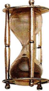
Sablier En un temps déterminé, le sable s'écoule par un trou du vase supérieur vers le vase inférieur.
