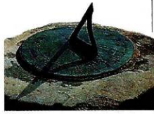
Cadran solaire L'ombre du style se déplace sur un cadran circulaire divisé en heures.
