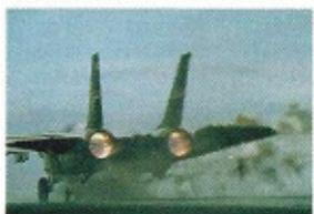
dispositif permettant d'augmenter temporairement la puissance de leurs réacteurs. Le principe de la post-combustion consiste à réinjecter du kérosène dans les gaz chauds en sortie de la tuyère d'échappement, comme dans une seconde chambre de combustion : cela a pour effet d'augmenter fortement la température
