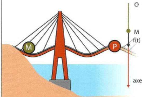
Nous étudierons ce système plus à fond ultérieurement, pour l'instant contentons-nous d'une interprétation au premier degré, lorsque la fréquence du pas des militaires approche la fréquence caractéristique du pont – les mouvements du pont et des bottes « se synchronisent » en quelque sorte –, l'amplitude d'oscillation du tablier augmente, jusqu'à ce que celui-ci atteigne son point de rupture.
